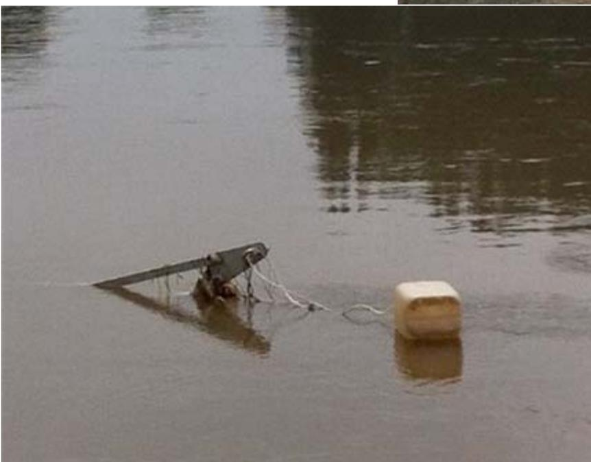
Une bouée de fortune est accrochée à l'extrémité de la grue pour signaler sa présence en cas d'immersion totale et réduire les risques de collision.
